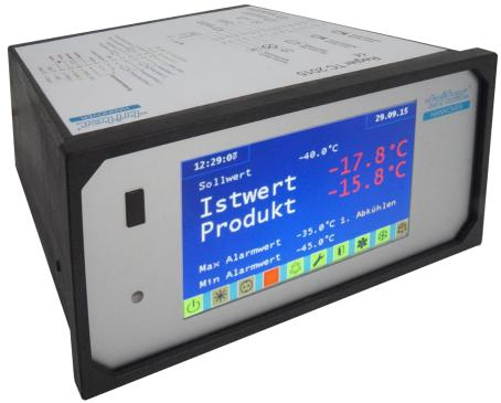
Der **TC3004** ist ein Kompaktregler im Standard-Einschubgehäuse, konzipiert zur Regelung von Kälte- oder Wärmeanlagen. Visualisierung und Bedienung erfolgen über ein 5"-Farbdisplay mit Touchscreen, Ethernet und USB dienen der Systemintegration.
